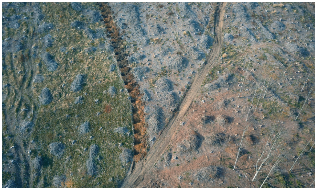
Obr. 4: Inovativní metodu lze realizovat ve velmi prudkých svazích (až 43°). Na snímku je vidět srovnání linky se zásahem a bez zásahu.
