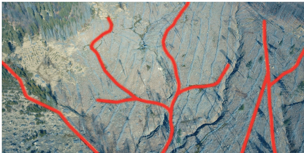
Obr. 7: Nově vzniklá síť přibližovacích linek odvodňuje krajinu
